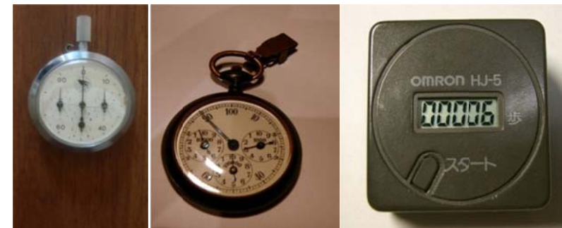
1 2 3 Նկար 34. Քայլաչափեր՝ 1, 2 – մեխանիկական, 3 - էլեկտրոնային
