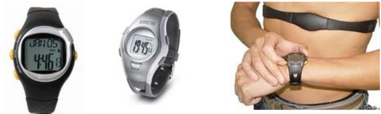
Նկար 36. Պուլսոմետրերի տարբերակներ. 1 – ձեռքի և 2 -կրծքի դիստանցիոն պուլսոմետր և ընդունիչ
