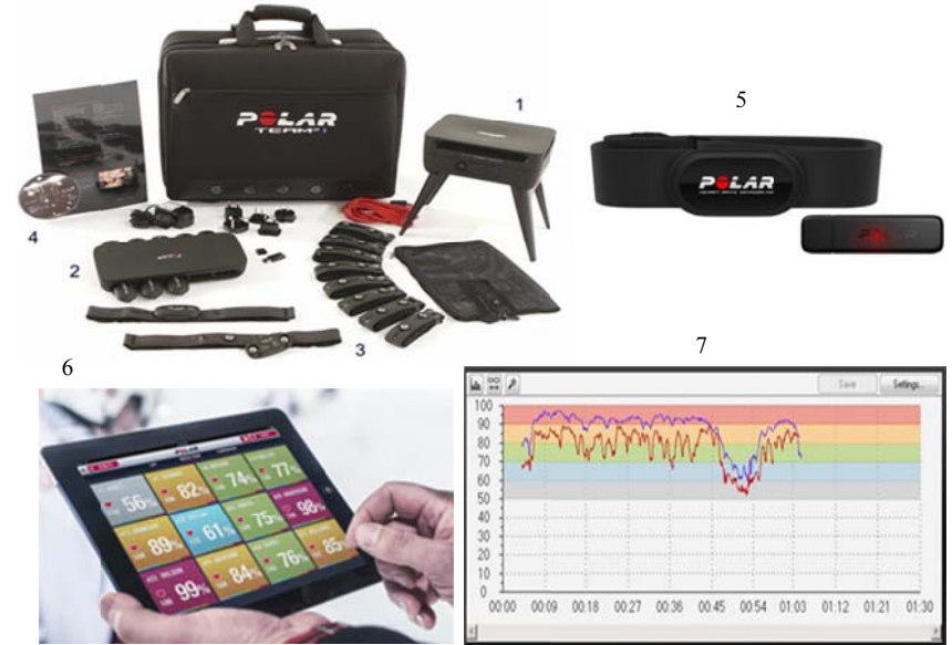
Նկար 64-1. Անոթազարկի հաճախականության հսկողությունը Polar Team համակարգ. 1 – հիմնական կայան, 2 – լիցքավորիչ, 3,5 – կրծքի պուլսոմետրեր, 4 – ծրագրային ապահովում, 6 - iPad պլանշետ, 7 - անոթազարկի կորը (ֆիզիոլոգիական կորը)
