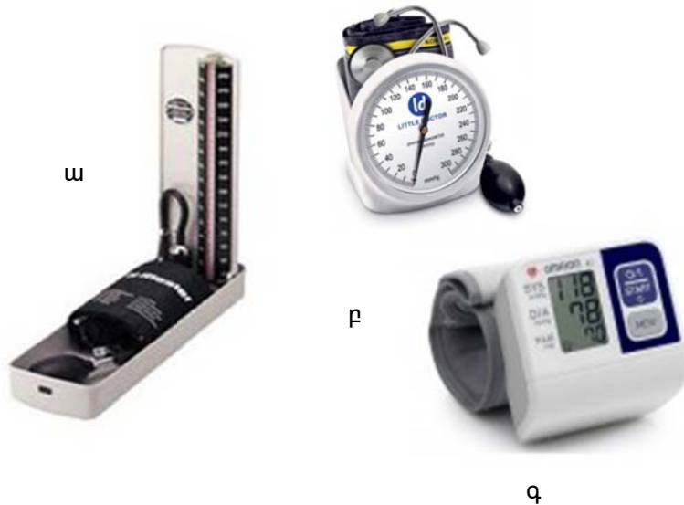
Նկար 39. Ճնշաչափերի (տոնոմետրերի) տեսակները՝ սնդիկային (ա), մեխանիկական (բ), էլեկտրոնային(գ)
